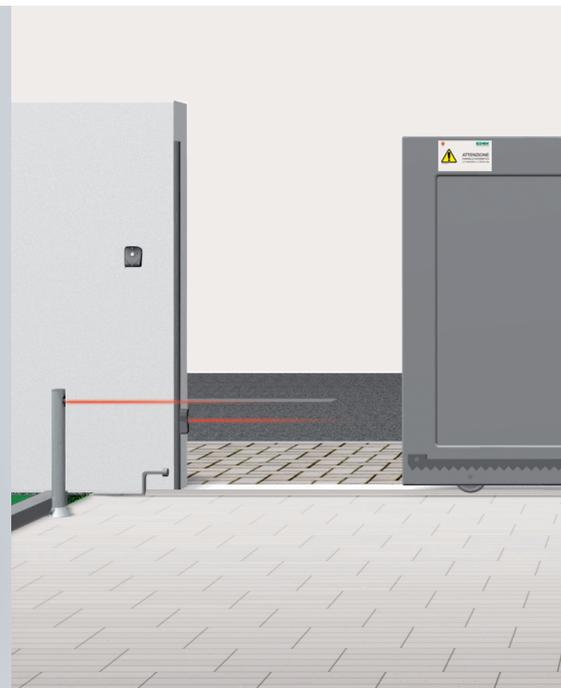
Automazione, serie ES, per cancelli scorrevoli in ambito residenziale, condominiale e industriale ad uso intensivo. L'attuatore elettromeccanico irreversibile è dotato di un motore in bassa tensione, 12 Vcc, e uno sblocco meccanico che permette di aprire e chiudere il cancello manualmente. La scheda elettronica di comando è integrata al corpo dell'attuatore. Tutti gli attuatori sono predisposti per l'alloggiamento della batteria tampone art. ZBA1 (opzionale).
