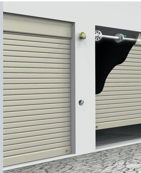
I motoriduttori elettromeccanici serie ZP per serrande avvolgibili reversibili o irreversibili, dispongono di un dispositivo di fine corsa con memoria meccanica, autoregolante in modo da ottenere l'arresto della serranda alcuni centimetri prima che essa incontri il suo fermo meccanico durante la manovra di apertura.
