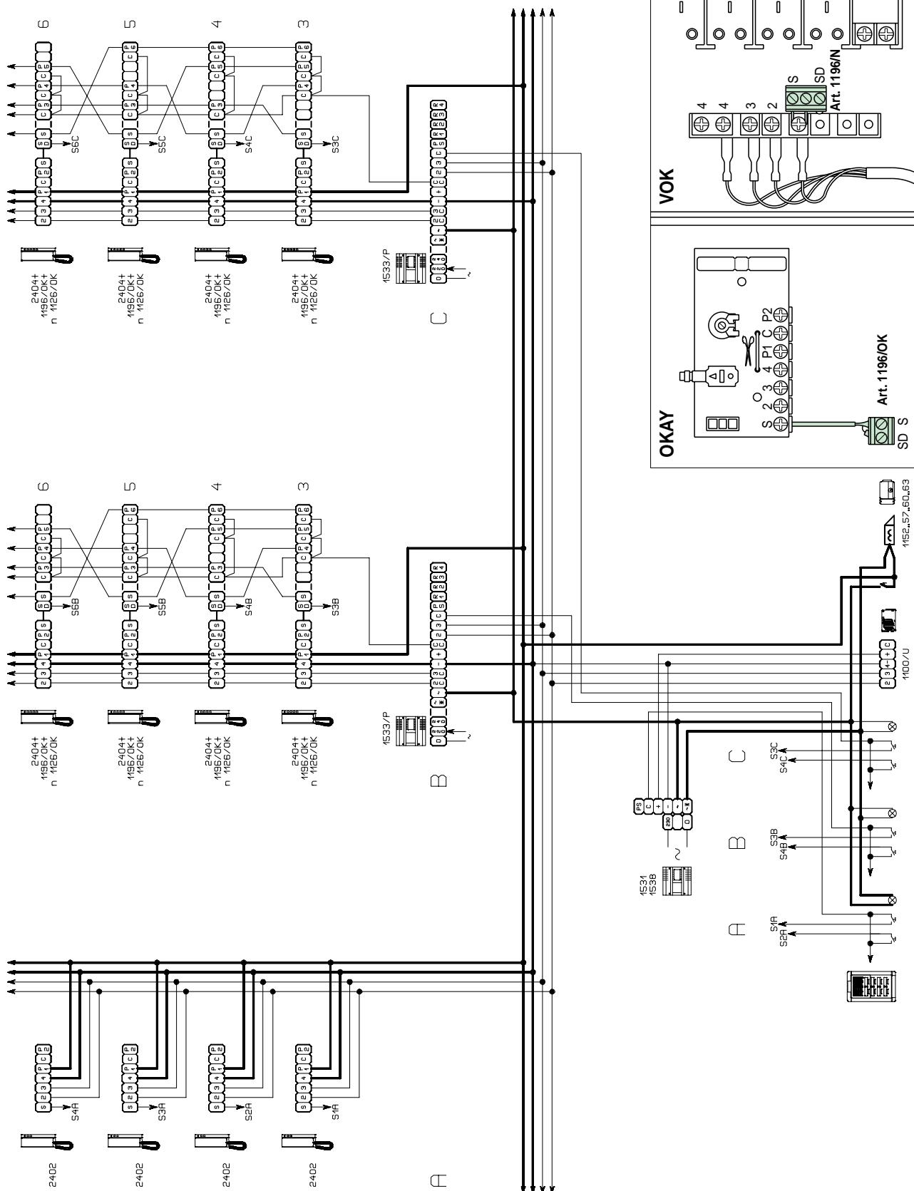
C5/17 Impianto di portiere con 2 posti esterni ed elettroserrature abbinate
